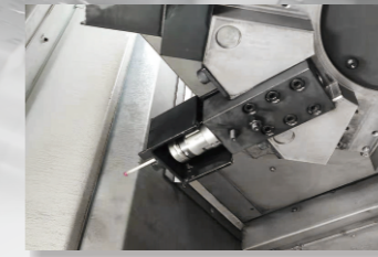
工件在线测量装置
